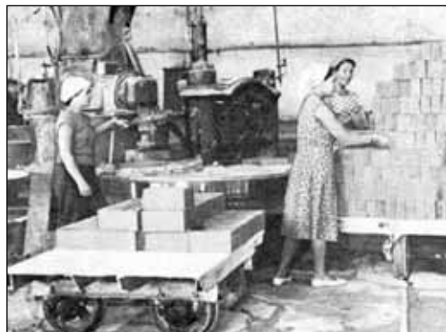
Формовка и укладка кирпича-сырца на вагонетку (так работали до 1963 года). Фото из архива редакции.
