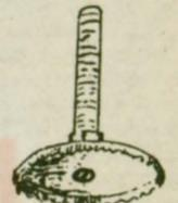
на болт, закрепив двумя контргайками, и сверлите.
